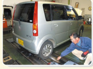
⑥検査 国家資格を持つ検査員がブレーキやライトなど保安基準に基づく検査を実施
